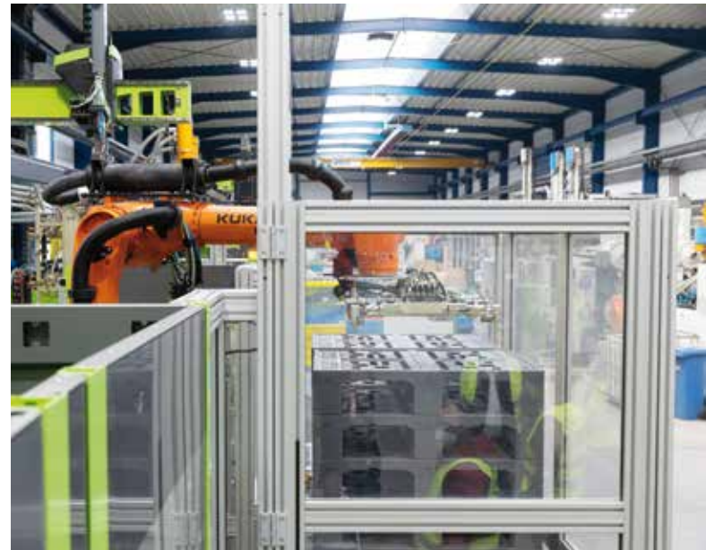
Jede einzelne Palette wird mit einem individuellen Etikett versehen, geprüft und außerhalb der Maschine aufgestapelt.
