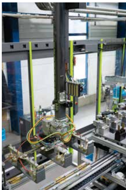
Aus der zweiten Spritzgießmaschine kommen die drei Kufen der Palette.
