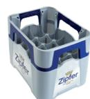
> Flaschenkasten mit Rundeckendesign und umlaufender zweiter Komponente aus TPE, sowohl im Griffbereich als auch als Designeffekt, Labels durch In-mould-labeling angebracht.
