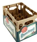
> Flaschenkasten im Mehrfarbdesign. Die zweite Farbkomponente wird zur Umrahmung des In-mould-Labels eingesetzt. Die Griffbereiche an den Schmalseiten sind durch die Gasinjektionstechnik im Querschnitt vergrößert.
